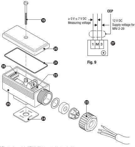
$\textbf{Fig. 9} \ \textbf{Electronic} \ \textbf{module} \ \textbf{NRV} \ \textbf{2-29} \ \textbf{integrated} \ \textbf{in terminal box}$
